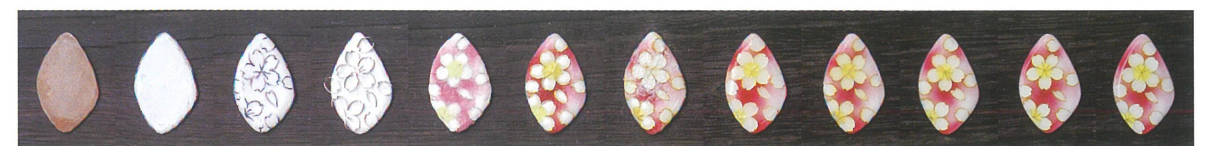
左から、完成するまでの作業工程。素地に下地と下絵つけ、植線したのち、施釉と焼成を繰り返し研磨するまで。大きさによっては数か月かかることも。
