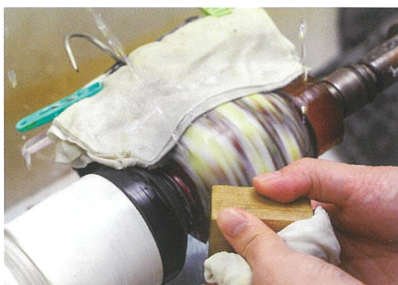
昔は研磨に砥石を使っていたが、現在では機械化、ダイヤモンドペーパーが主流に。
