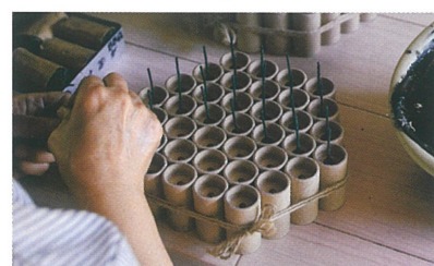
フタをしたら導火線を刺していく。
