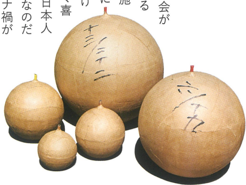
写真の中で最も大きい一尺玉(10号玉)は直径約30cm。二尺玉ともなると、多くの作業が数人掛かりとなる。
