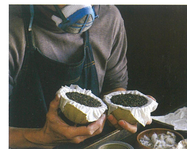
玉柄というパーツに星を並べ、半分ずつを両手に持ち、一気に左右を閉じ合わせる。
