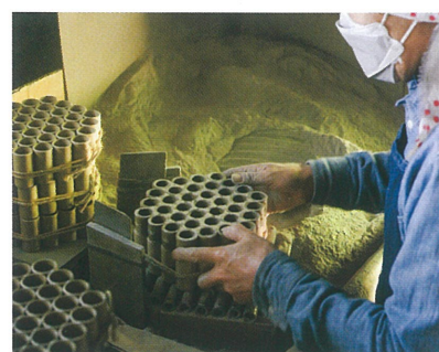
火薬や金属などを混ぜた粉状の星を、紙パイプに詰める。
